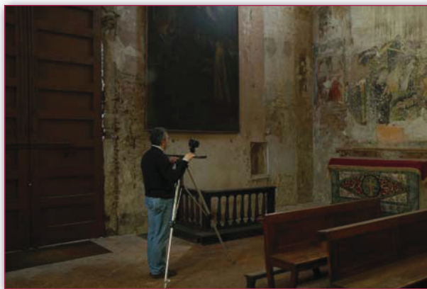
Figura 1 - Fase di presa di una "tripletta" di immagini per un affresco murale.
