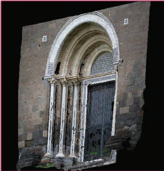
Figura 3 - Una vista della nuvola di punti che genera il modello 3D.
