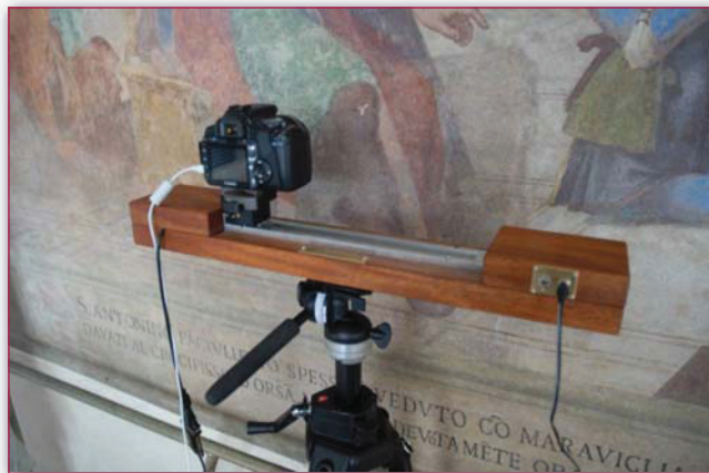
Figura 6 - Zscan versione Micro per analisi di dettaglio e distanze di presa ravvicinate.
